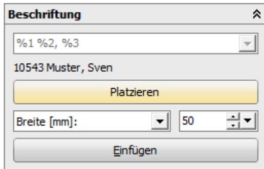
Im Panel kann ein Text vorgegeben und in Höhe oder Breite eingestellt werden, der bei aktiver Taste [Platzieren] parallel zum Bildschirmkoordinatensystem und mittig zu der mit rechtem Mausklick gewählten Objektposition als blau hinterlegte Vorschau im [3D-View](#) angezeigt wird.
